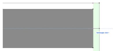
No ambiente 3D é possível notar que há discordância de materiais. Entre nas definições novamente, clique em **Representação 3D**, na aba **Espessura**, e habilite a opção **Use Material de Construção da Camada da Parede**. Desse modo, o fim da parede terá o(s) mesmo(s) Material(is) de Construção e Superfície da parede.
