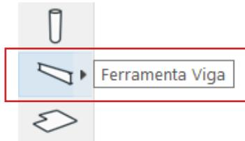
Para abrir a janela de **Definições dos Padrões da Viga**, basta clicar duas vezes na ferramenta **Viga**, na aba **Modelagem**. Também podemos selecionar uma viga existente e teclar (Ctrl + T), no Windows ou (Command + T), no MAC.
