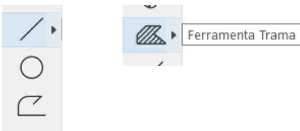
Para desenhar o perfil podemos utilizar a criem linhas, mas lembre-se que **um perfil complexo é formado por tramas e não por linhas**. Por isso, ao final do seu desenho, é necessário selecionar a ferramenta **Trama** e preencher todo o perfil com a trama referente ao material de construção correto (utilize a **Vara Mágica**, pressionando a "barra de espaço").
