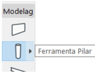
Para abrir a janela de **Definições dos Padrões do Pilar**, basta clicar duas vezes na ferramenta **Pilar**, na aba **Modelagem**. Também podemos selecionar um pilar existente e teclar (Ctrl + T), no Windows ou (Command + T), no MAC.
