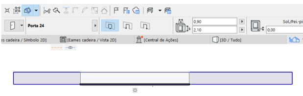
Para se inserir a porta em uma parede, você deve clicar na aresta externa da parede e então definir o sentido de abertura.
