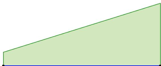
**Parede trapezoidal:** Possibilita que a parede tenha espessuras diferentes no início e no fim.
