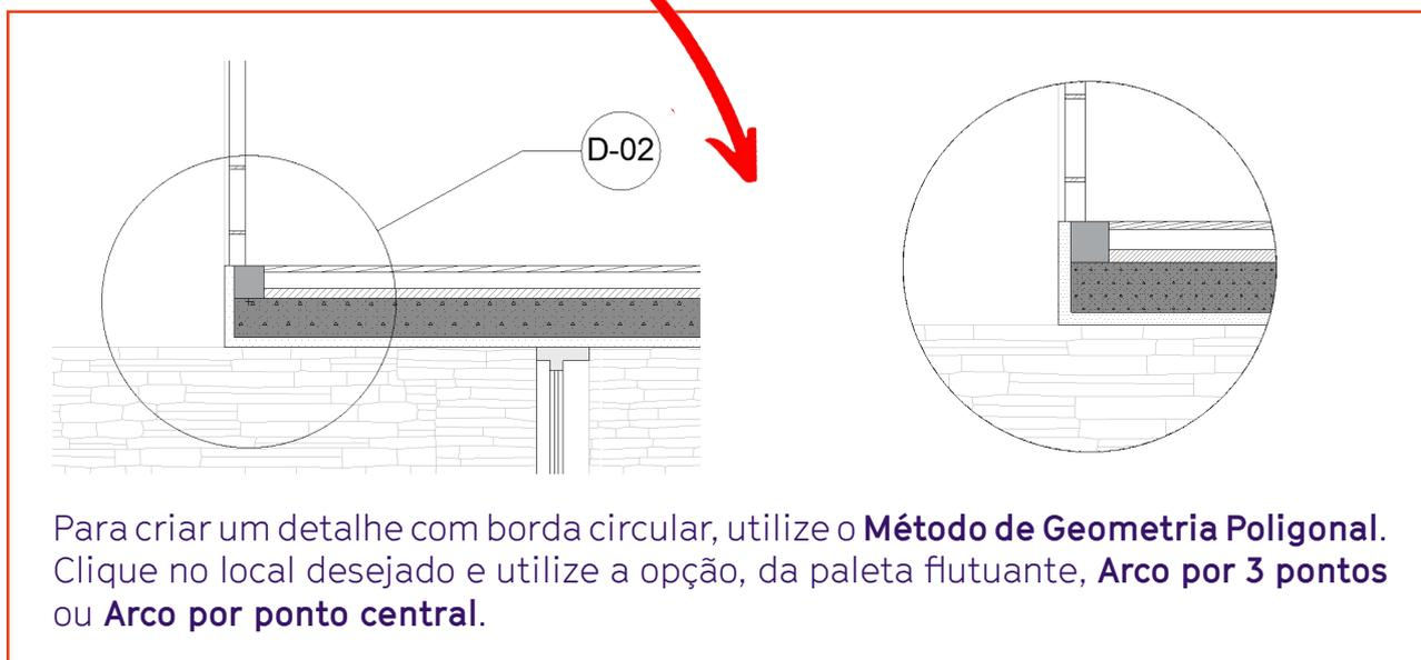
Para criar um detalhe com borda circular, utilize o **Método de Geometria Poligonal**. Clique no local desejado e utilize a opção, da paleta flutuante, **Arco por 3 pontos** ou **Arco por ponto central**.
