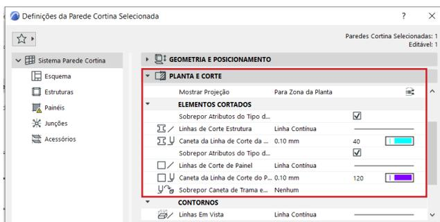
Podemos configurar individualmente as canetas de corte de cada elemento da parede cortina, mas na aba **Planta e Corte**, dentro de **Definições da Parede Cortina Selecionada**, temos os **Elementos Cortados**, onde podemos sobrepor essas canetas.
