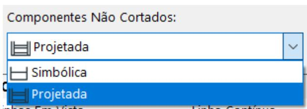
Após desenhar a parede cortina, podemos selecionar em **Planta e Corte**, no **Modo de Exibição**, que os **Componentes Não Cortados** devem ser mostrados de forma **Projetada**, para melhor visualização dos elementos.
