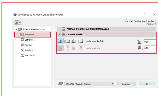
Dentro das **Definições da Parede Cortina Seleccionada**, em **Esquema**, temos a aba “**Origem do Padrão**”, onde podemos escolher o ponto de origem da paginação da parede cortina.
