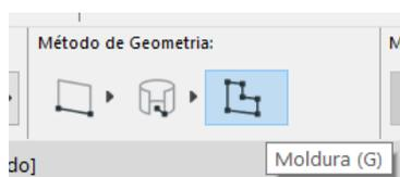
Para construirmos uma parede cortina no plano horizontal, utilizamos, na vista em planta, o **Método de Geometria Moldura**.
