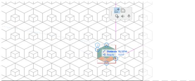
O próximo passo é ajustar essa moldura, através de sua arestas e vértices, em volta do nosso padrão, fazendo com que ele seja repetido por toda a área da parede cortina após aplicarmos esse ajuste.
