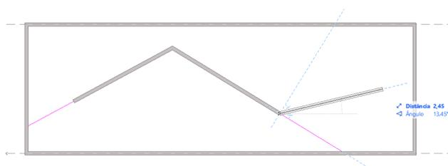
Agora, na elevação, podemos desenhar o padrão personalizado, utilizando os elementos de uma parede cortina (montantes, painéis, etc).
