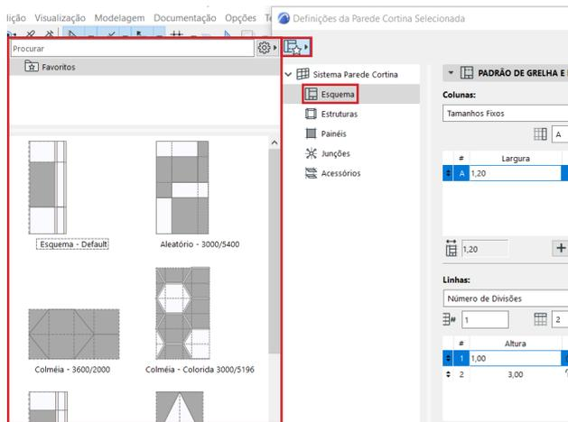
Dentro das definições da Parede Cortina Selecionada, em Esquema, existem diversos favoritos de Esquemas, com várias geometrias diferentes.
