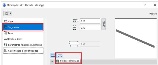
Para criar uma bancada com saia, por exemplo, podemos utilizar a ferramenta viga, mas multissegmentada.
