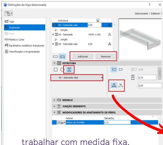
Devemos então adicionar ou remover os segmentos, de acordo com o elemento e escolher os segmentos específicos criados anteriormente, com perfis complexos.
