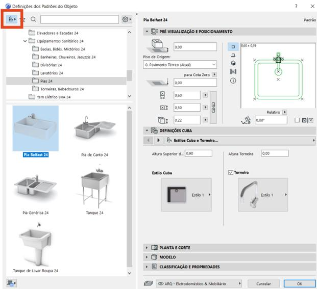
Por fim, para inserir uma pia na bancada, abra as **Definições** da ferramenta **Objeto**, vá na aba **Mecânica** > **Equipamentos sanitários** > **Pias**. Dentro da aba **Pias**, selecione o modelo **Pia Belfast**.
