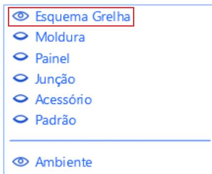
Entrando em uma Elevação da nossa parede cortina, podemos habilitar o ambiente de edições e deixar somente o **Esquema Grelha** ligado. Desse modo, somente o contorno será visível. Podemos, então, modificar esse contorno para uma forma desejada e todos os elementos se adequarão à nova forma, seguindo os parâmetros da parede cortina.
