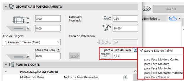
Em **Definições da Parede Cortina Seleccionada > Sistema Parede Cortina > Geometria e Posicionamento**, na coluna da direita podemos alterar a posição e o afastamento da Linha de Referência da parede cortina seleccionada.
