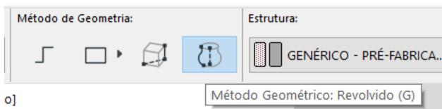
Podemos modelar garrafas, vasos, luminárias utilizando o **Método de Geometria Revolido**.
