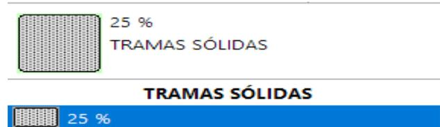
Após a seleção, ainda em **Tramas de Superfície**, numere a caixa na linha **Caneta da Trama de Superfície** com “214”. Em seguida, clique no retângulo à direita e escolha uma cor para a representação.
