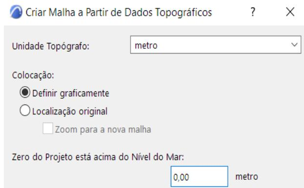
Para iniciar a modelagem siga: **Arquivo > Interoperabilidade > Criar Malha a Partir de Dados Topográficos**. Em sequência, escolha o local do arquivo de texto com as coordenadas do terreno.
