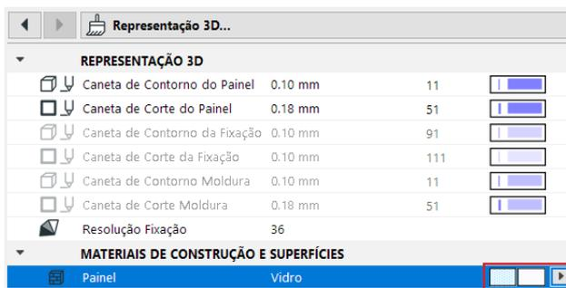
Na opção **Materiais de Construção e Superfícies**, vá em **Painel** e troque o material pré-configurado “**Vidro**” para “**Tijolo Cerâmico**”, clicando no retângulo do canto direito.
