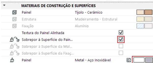
Habilite a opção **Sobrepôr a superfície do Painel** e configure o tipo de superfície como “**Pintura - Branco Polido**”.
