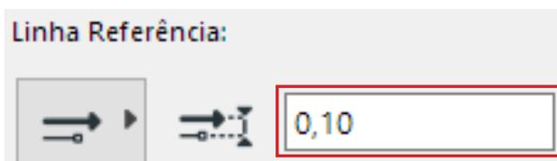
Uma caixa irá ser ativada. Insira o valor da metade da espessura do muro.
