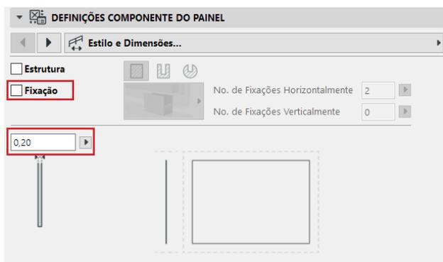
Na aba **Definições Componente do Painel**, desabilite a opção **Fixação** e insira o valor da espessura do painel (muro).
