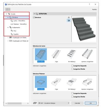
Na coluna da esquerda temos como modificar elementos específicos da **estrutura** e do **acabamento** da escada.
