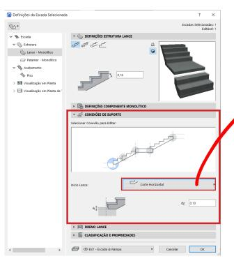
Em Lance, dentro de Estrutura, há a aba Conexões de Suporte. Essa aba nos permite escolher como será feita as conexões entre: lance-laje, lance-lance e lance-patamar.
