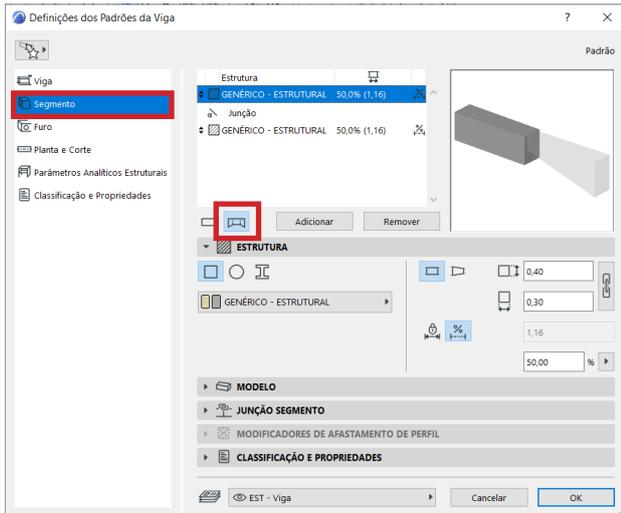
Uma viga segmentada é uma viga com segmentos diferentes entre si, ou seja, como se fossem diversos tipos de vigas “grudadas” uma na outra.
