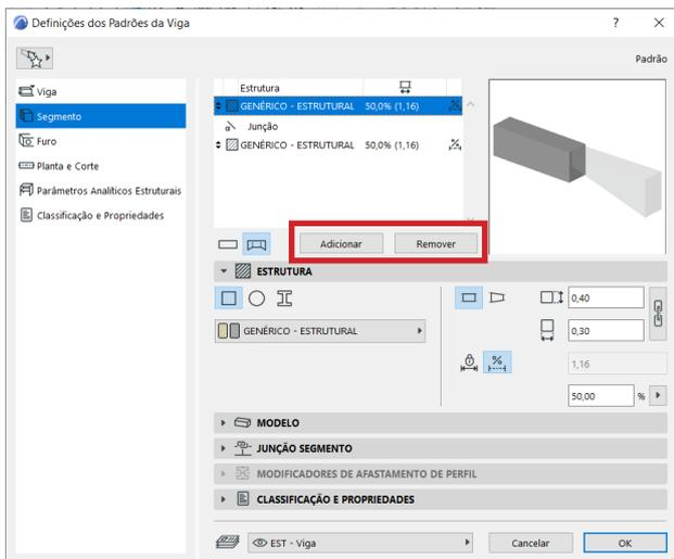
Para adicionar novos segmentos à viga, clique em **Adicionar**. Para remover segmentos, selecione o segmento e clique em **Remover**.
