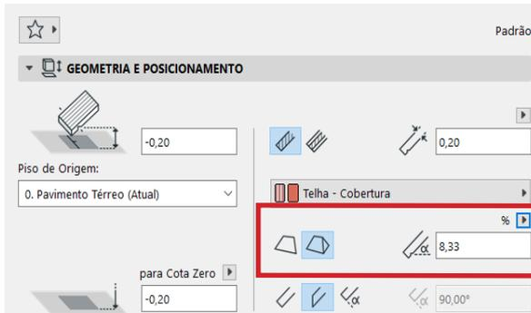
uma inclinação abra as **Definições da ferramenta Cobertura**, vá na aba **Geometria e Posicionamento**, selecione a opção **Inclinado** e insira o valor em porcentagem na **Inclinação da Cobertura**. Em seguida, clique no ícone **Selecionar Unidade de Inclinação** (setinha logo acima) e altere para graus. O valor em porcentagem será convertido para um valor em graus.
