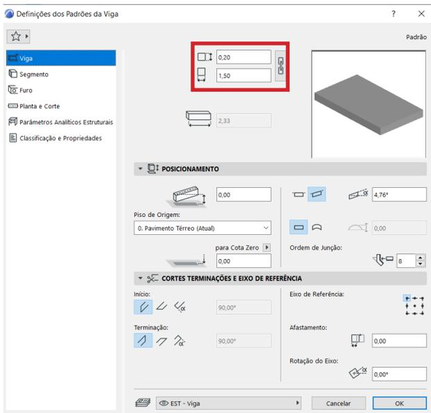
É necessário indicar a altura e largura desejadas na aba das propriedades da viga. Em seguida, precisamos designar a inclinação da viga, mas em graus e não em porcentagem, como visto no exemplo da ferramenta **Cobertura**, na aula anterior.
