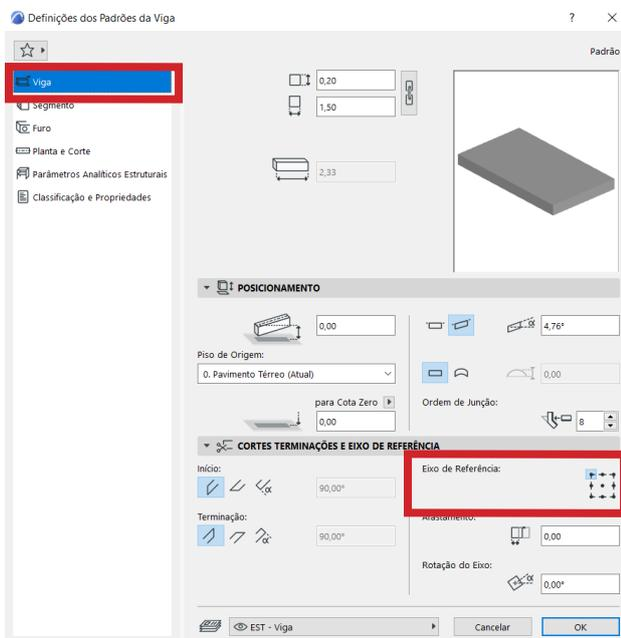
Volte para a área Viga, abra a aba **Cortes Terminações e Eixo de Referência**, vá em **Eixo de Referência** e escolha o ponto superior esquerdo. Agora a rampa estará pronta para ser inserida no modelo.
