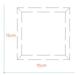
Posicione o pilar em um vértice da laje e, após isso, utilizando o atalho (Ctrl+D), afaste-o de cada aresta em 15cm.
