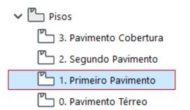
Copie a laje e os pilares com (Ctrl+C), vá para o pavimento acima do atual e cole com (Ctrl+V).
