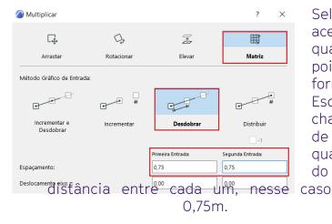
Selecione o pilar e, com o atalho (Ctrl+U), acesse a ferramenta Multiplicar. Entre as quatro opções de ação, selecione a Matriz, pois os pilares seráo colocados tanto de forma horizontal quanto verticalmente. Escolha o Método Gráfico de Entrada chamado **Desdobrar**. Por fim. nas opcões de Espaçamento, tanto de primeira quanto de segunda entrada use o valor do tamanho da base do pilar somado a
