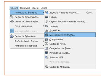
Para o recorte do volume de ar ocorrer na laje, é preciso que esse material tenha uma prioridade maior que o material usado na laje (nesse caso o "Concreto Armado - Estrutural").
