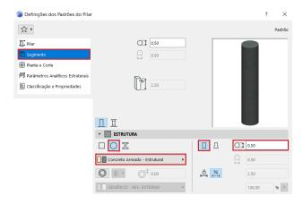
Ainda nas Definições, vá para a área **Segmento** e, na aba **Estrutura**, escolha a forma **Círculo**. Altere o material para "**Concreto Armado - Estrutural**" e mude o tamanho **Afunilado** para **Uniforme**. Por último, dê o valor do campo **Diâmetro**, nesse exemplo, como "0,50m".
