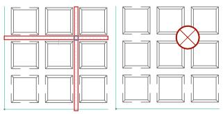
Para posicionar os pilares estruturais, trace linhas guias verticais e horizontais que se encontrem no meio das nervuras. Por fim, insira o pilar nesse ponto de encontro.
